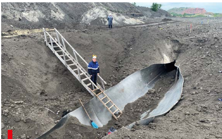
Трубы большого диаметра для газопровода нового поколения подвергли натурным пневматическим испытаниям
